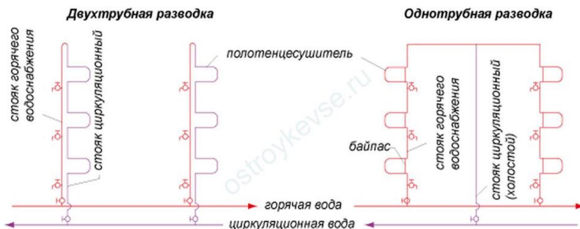
Рис. 1 Схема разводки трубопроводов
