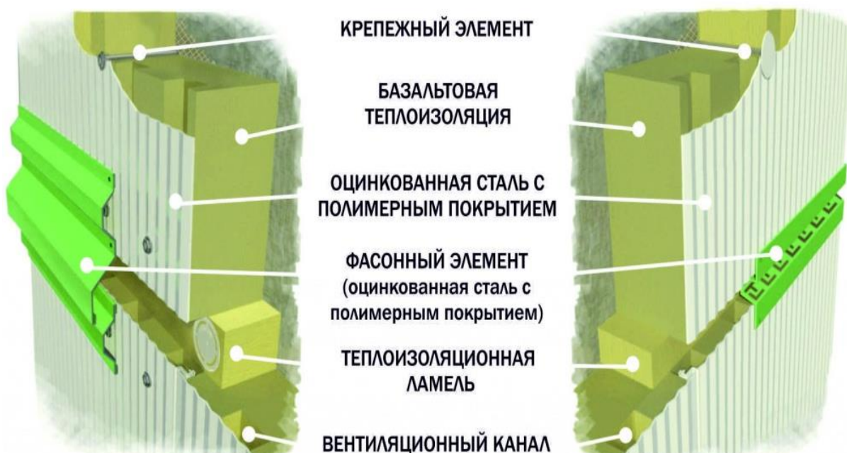
Рис. 1. Схема элементов СУФ
