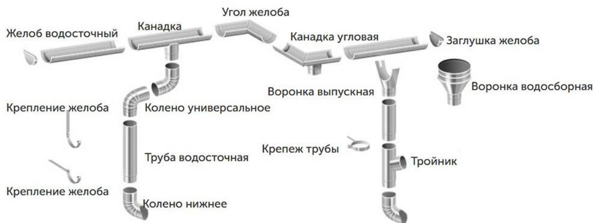
Рис. 1 Схема элементов наружного водостока.
